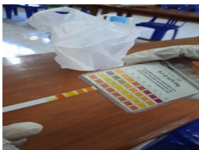
Gambar 7 : Pengujian pH pada kandungan minyak jelantah setelah pemanasan
