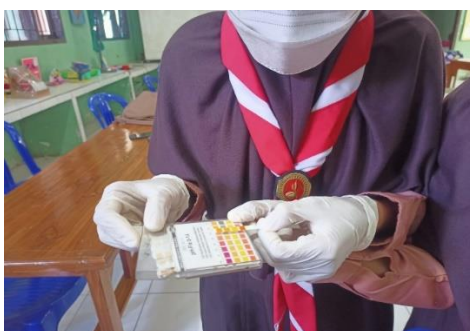
Gambar 6 : Pengujian pH pada kandungan minyak jelantah sebelum pemanasan
