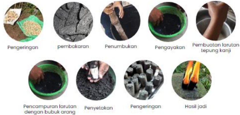
Gambar 1. Cara Pembuatan Briket Janggal Jagung
